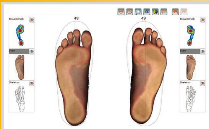
Die importierten Kundendaten dienen als Basis für die Konstruktion. Zunächst muss der Umriss der gewünschten Konstruktion in Länge und Breite an den Fuß angepasst werden.
